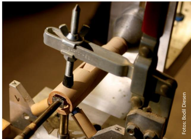
Alec Loretto's **Windway-Cutter** war lange Zeit für beinahe jeden Blockflötenmacher eine unverzichtbare Maschine. Mit ihrer Hilfe müssen Windkanäle nicht mehr von Hand in den Blockflötenkopf getrieben werden. Beim Windway-Cutter wird der Kopf zunächst in einer Position fixiert. Danach kann durch einen per Wippe gesteuerten Mechanismus ein beliebig geformtes Schneidmesser in einem eingestellten Winkel stufenweise der Windkanal ausgearbeitet werden.
