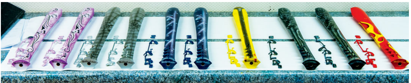
Die sogenannte 0-Serie der Elody in unterschiedlichen Ausführungen: Zu sehen sind oberflächenfertige Instrumente, die auf die Montage der Klappenmechanik sowie das Einbohren und das sogenannte Stoßen von Windkanal und Labium warten.
