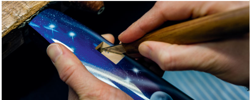
Ein Blick auf Produktionsstadien der Elody bei Mollenhauer: Das Einspannen und Einbohren eines Mittelteils, das Fertigrichten der Klappen und das Nachschneiden des Labiums.
