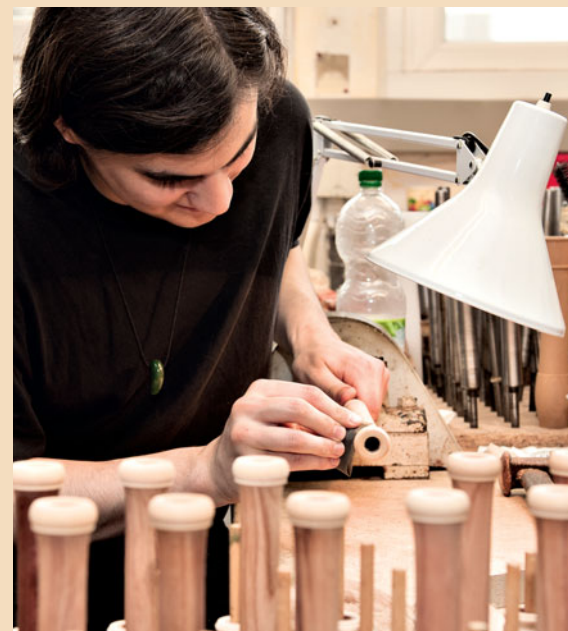
Hier sehen wir Leon Peschke beim Handschleifen der Oberfläche der neuen Traum-Edition Sopran von Mollenhauer.
