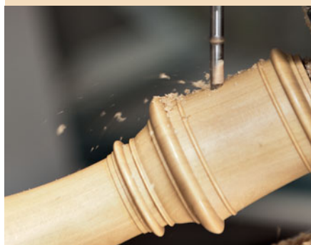
Peter Storch bohrt die Tonlöcher an der richtigen Stelle und mit dem korrekten Durchmesser. Nach dem Bohren achtet er darauf, dass die Instrumententeile sauber und frei von jeglichem Holzstaub sind.
