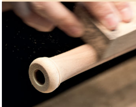
Hier sehen wir Leon Peschke beim Handschleifen der Oberfläche der neuen Traum-Edition Sopran von Mollenhauer.
