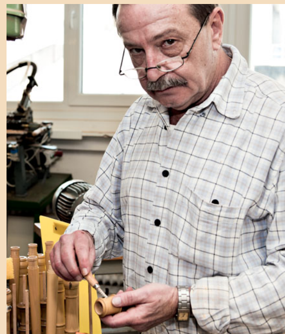
Peter Storch bohrt die Tonlöcher an der richtigen Stelle und mit dem korrekten Durchmesser. Nach dem Bohren achtet er darauf, dass die Instrumententeile sauber und frei von jeglichem Holzstaub sind.
