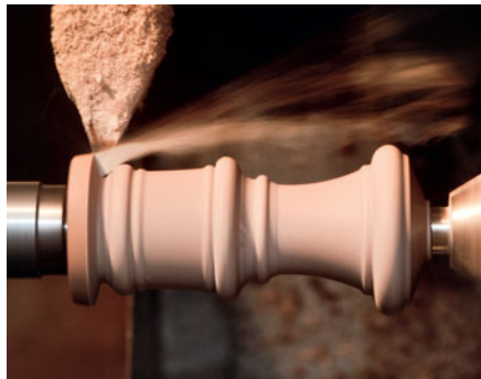
In der Drechserei sorgt Norbert Schultz für saubere, maßhaltige und glatte Drechseloberflächen.
