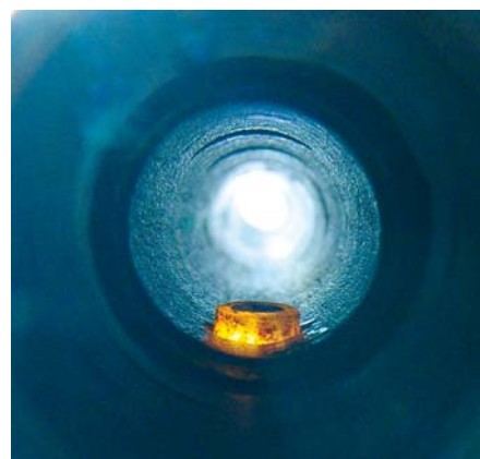
Abb. 7b: Innenaufnahme desselben Instruments im Gegenlicht und mit von außen angestrahelter Daumenlochbuchse, welche deutlich in die Innenbohrung übersteht. Damit wird ein altbekanntes Problem eingedämmt. Blasfeuchtigkeit kann während des Spielens nicht mehr ins Daumenloch rinnen und dieses blockieren.
