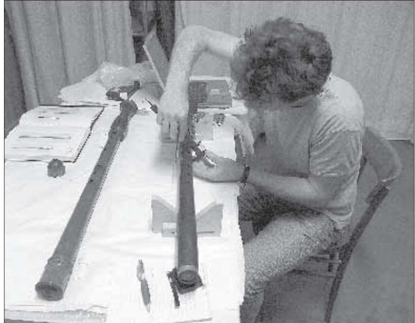
Adrian Brown möchte alle erhaltenen Renaissance-Blockflöten neu vermessen. Hier beim Abnehmen der Außenmaße bei einer Bassblockflöte.
