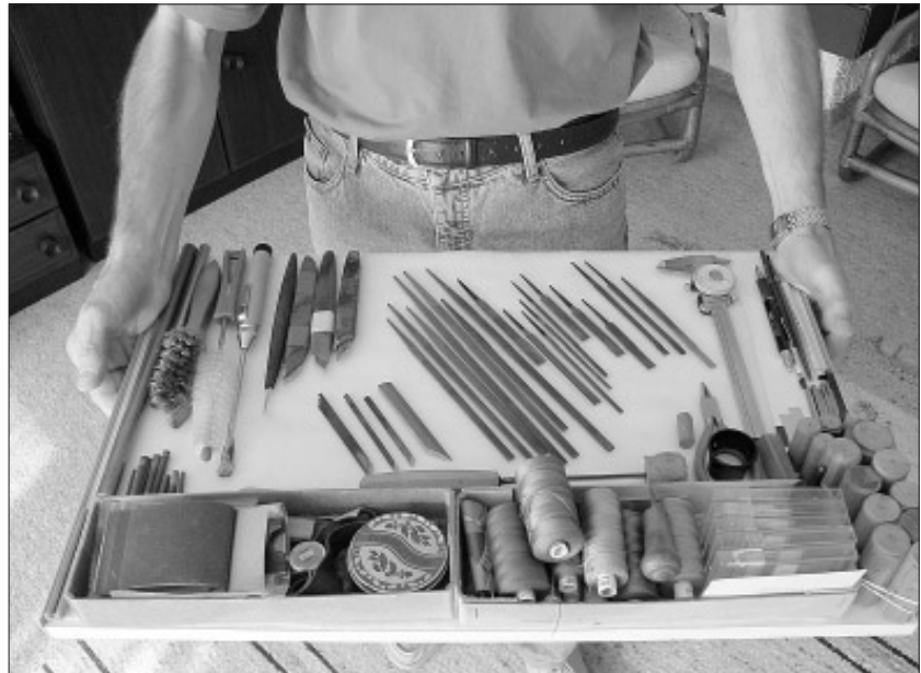
Tonangebend: Ammanns mobiles Intonierwerkzeug fürs Voicing der Flöten.
