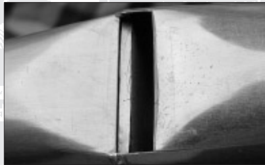
Fensteransicht bei einer Metallpfeife mit fix eingelötetem Bleikern
